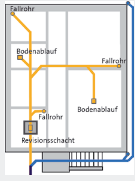
Abb. 6: Abbiegefähige TV-Kameras folgen dem Verlauf der Grundleitungen und dokumentieren deren Zustand. (hanseWasser)
