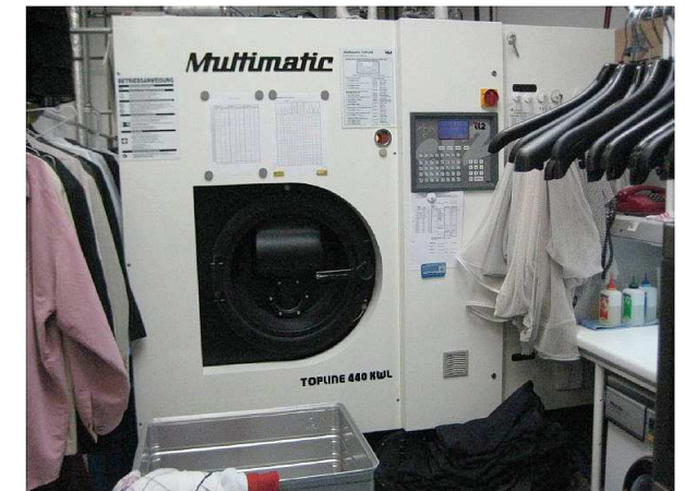
Eine moderne KWL-Reinigungsmaschine
