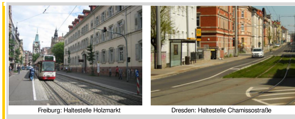
Abbildung 5.4: Praxisbeispiele Haltestelle mit angehobener Fahrbahn
